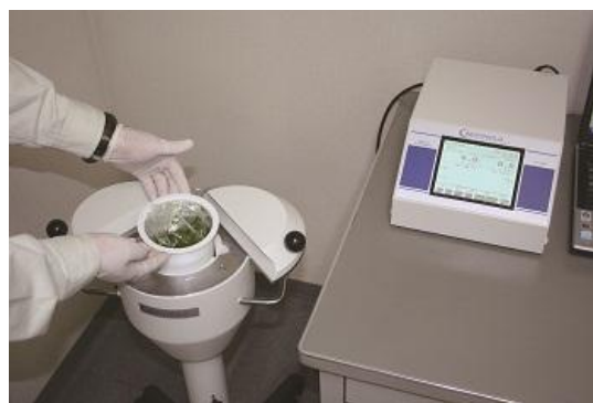
▲分析機器 (NaI(Tl)シンチレーションスペクトロメータ)
