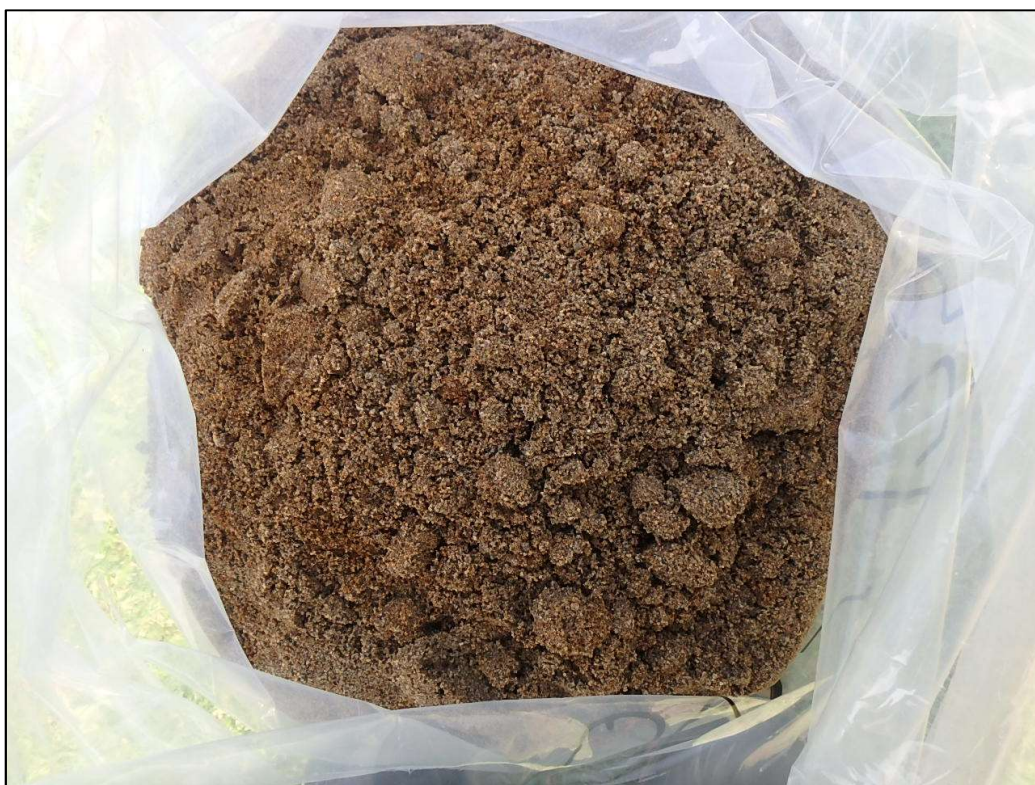
写真-5.2.2 CBR-2 採取試料 (CBR=12.5%)
