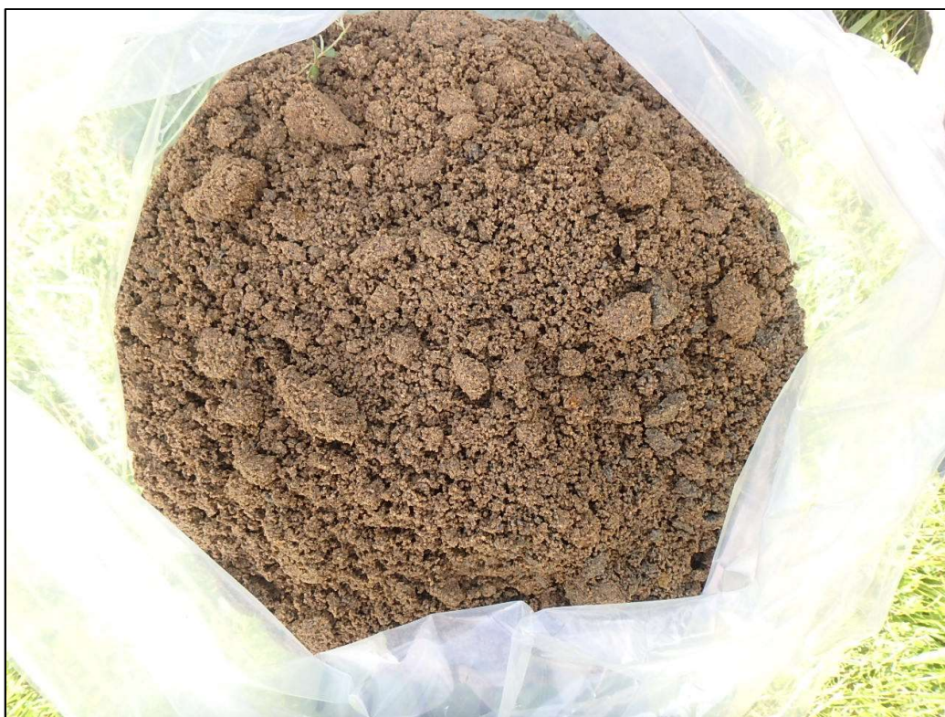
写真-5.2.1 CBR-1 採取試料 (CBR=2.3%)
