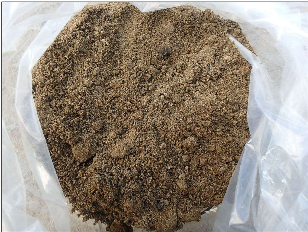
写真-5.2.4 CBR-4U 採取試料 (CBR=0.6%)
