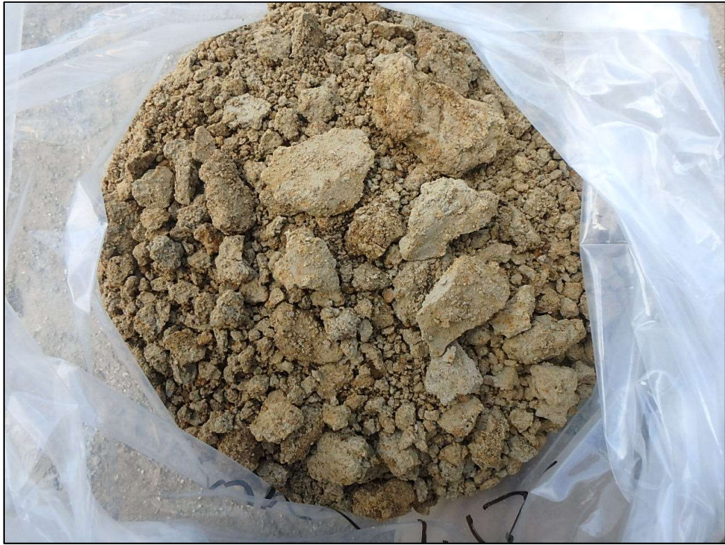
写真-5.2.5 CBR-4L 採取試料 (CBR=1.1%)
