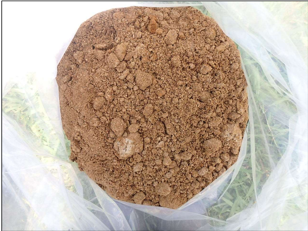
写真-5.2.3 CBR-3 採取試料 (CBR=0.5%)
