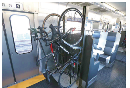
▲車内サイクルラック(JR東日本千葉支社提供)
