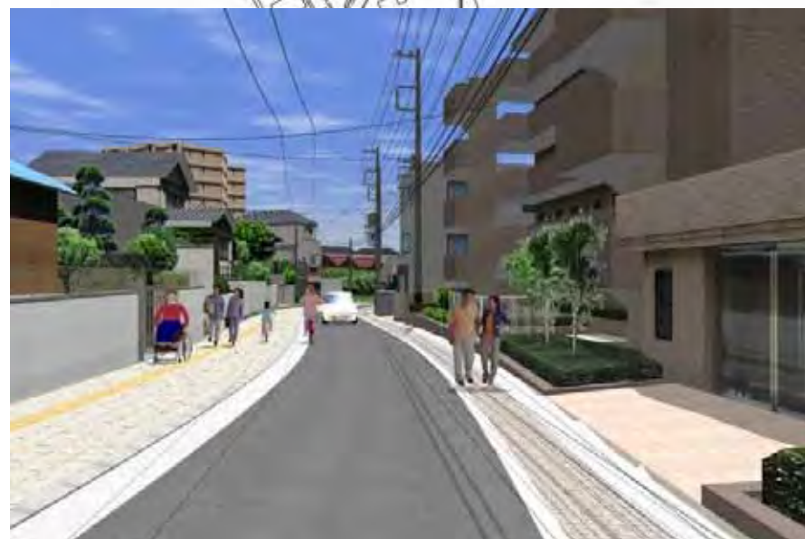
北 一方通行・片側歩道 歩道/インターロッキング舗装、車道/アスファルト舗装案
